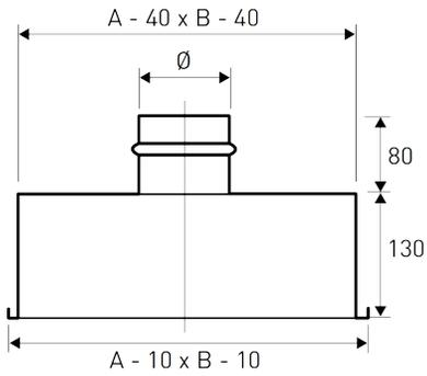
**Plenum en acier 1 piquage aligné pour diffuseur sur dalle de faux plafond**
