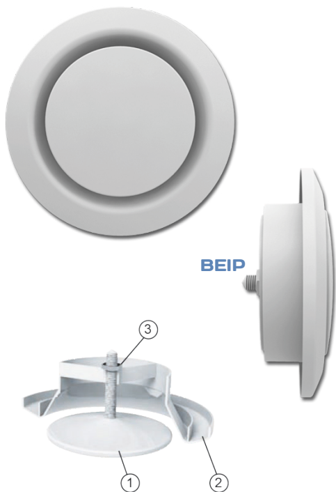
(1) Obturateur central réglable (2) Corps (3) Ecrou Matière : polystyrène
