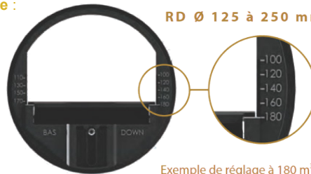
Exemple de réglage à 180 m³/h : régulateur calé sur le repère droit «180»
