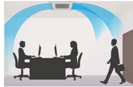
Diffusion d'air confortable en évitant le soufflage direct sur l'occupant.
